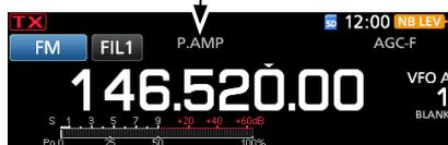
**NOTA:** Cuando utilice el preamplificador durante la recepción de señales potentes, la señal de recepción podría distorsionarse. En tal caso, apague el preamplificador.
