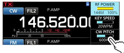
4. Ajuste el tono CW entre 300 y 900 Hz (en pasos de 5 Hz).
