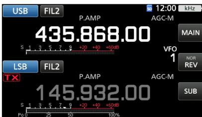
① Seleccione una frecuencia vacante dentro de la cobertura del satélite. Monitoree la frecuencia de funcionamiento para asegurarse de que la transmisión no ocasionará interferencias con otras emisoras.
