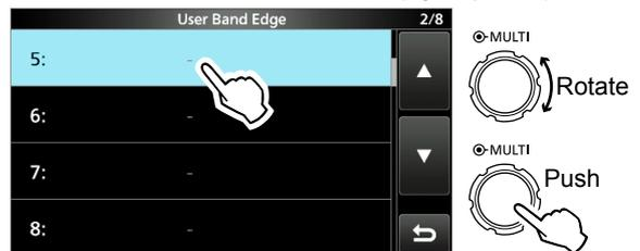
3. Introduzca la frecuencia del borde inferior de la banda y, a continuación, toque [ENT]. (Ejemplo: 430,1)
