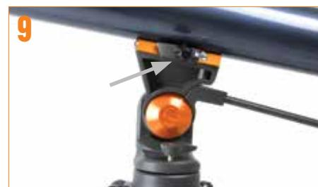
Centrez la queue d'aronde sur la monture et serrez la vis de fixation. Pour plus de sécurité, serrez la vis de verrouillage inclinée située à côté de la vis de fixation.
