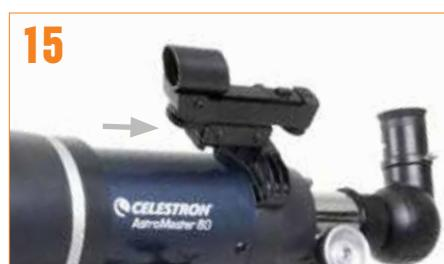
Para instalar el localizador del 80AZS: Afloje el tornillo manual en el soporte machihembrado en la parte superior izquierda del enfoque. Deslice el desplazador machihembrado en la parte inferior del soporte del localizador en el soporte machihembrado del enfoque. Apriete el tornillo manual para asegurarla en posición.
