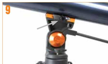
Centrare la coda di rondine nella montatura e serrare la vite di fissaggio. Per una maggiore sicurezza, serrare la vite di bloccaggio angolata accanto alla vite di fissaggio.
