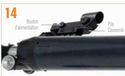
Retirez les deux languettes de plastique situées sous le capot de la pile en tirant dessus. Pour préserver la durée de vie de la pile, assurez-vous d'éteindre le chercheur lorsque vous ne l'utilisez pas.
