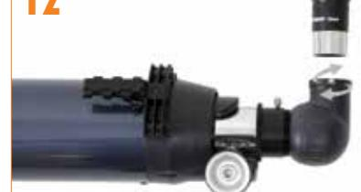
Setzen Sie das Chromrohr des 20mm-Okulars in die Diagonale ein und ziehen die Einstellschraube fest.
