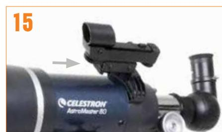
Pour installer le chercheur sur le 80AZS : Desserrez la vis à main sur la monture en queue d'aronde située sur le côté supérieur gauche du système de mise au point. Faites glisser la section coulissante de la queue d'aronde sur le support du chercheur sur la monture en queue d'aronde du système de mise au point. Serrez la vis à main pour le fixer en position.
