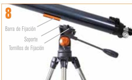
A continuación, deslice el tubo del telescopio en el soporte. Asegúrese de hacer retroceder los tornillos de fijación para dejar un espacio suficiente para la barra de fijación.
