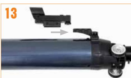
Pour installer le chercheur sur les modèles 70AZ, 90AZ et 102AZ : Desserrez les deux vis cruciformes sur le côté du chercheur et faites glisser la pince sur le support en queue d'aronde. Fixez le chercheur en place en serrant les deux vis cruciformes.
