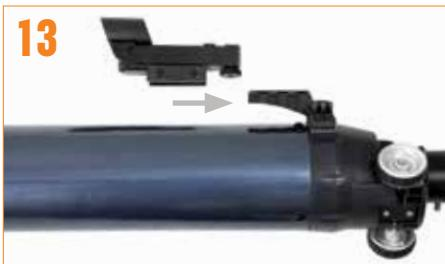
**Um das Sucherfernrohr auf dem 70AZ, 90AZ und 102AZ zu installieren:** Lösen Sie die beiden Kreuzschlitzschrauben an der Seite des Sucherfernrohrs und schieben die Klemme über die Schwalbenschwanzhalterung. Sichern Sie das Sucherfernrohr, indem Sie die beiden Kreuzschlitzschrauben anziehen.
