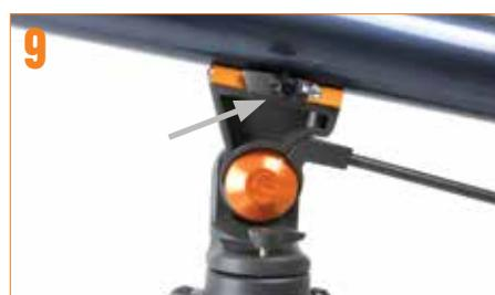
Centre la barra de fijación en el soporte y apriete el tornillo de fijación. Para mayor seguridad, apriete el tornillo de bloqueo en ángulo al lado del tornillo de fijación.
