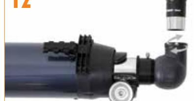
Introduzca el cañón cromado del ocular de 20mm en la diagonal y fíjelo con el tornillo.
