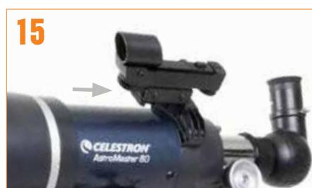
Per installare il cercatore su 80AZS: Allentare la vite con testa ad alette sul supporto a incastro su lato sinistro del dispositivo di messa a fuoco. Far scorrere il cursore a incastro sulla parte bassa della staffa del cercatore nel supporto a incastro sul dispositivo di messa a fuoco. Serrare la vite con testa ad alette per assicurare in posizione.
