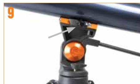
Schwanzschwanz in die Halterung eindrehen und Befestigungsschraube anziehen. Für mehr Sicherheit, ziehen Sie den abgewinkelten Riegel neben der Befestigungsschraube fest.
