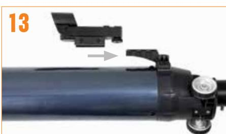
Para instalar el localizador en el 70AZ, 90AZ y 102AZ: Afloje los dos tornillos de cabezal Philips en el lateral del localizador y deslice la abrazadera sobre el soporte machihembrado. Asegure el localizador en posición apretando los dos tornillos de cabezal Philips.
