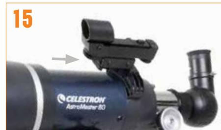
**Um das Sucherfernrohr auf dem 80AZS zu installieren:** Schwabenschwanzhalterung oben links am Okularauszug. Schieben Sie die Schwabenschwanz-Schiene an der Unterseite der Sucherhalterung in die Schwabenschwanzhalterung am Okularauszug. Ziehen Sie zum Sichern die Rändelschraube fest.
