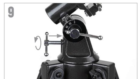
Suchen Sie im Internet oder mit einer Karte den ungefähren Breitengrad Ihres Beobachtungsorts. Schrauben Sie anschließend die Breitengrad-Einstellschraube in die äquatoriale Montierung, bis Ihr Breitengrad auf der Breitengradskala angezeigt wird.
