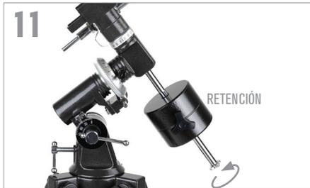
Sujetando el contrapeso con una mano, alinee la barra de contrapeso con el soporte. Con la otra mano, gire la barra de contrapeso hasta que quede totalmente asentada. Apriete el tornillo de bloqueo del contrapeso para sujetarlo en posición.
