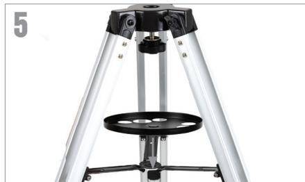
Platzieren Sie die Zubehörablage oben auf der mittleren Stativstützstrebe. Drehen Sie die Ablage in die Gewindeöffnung in der Mitte der Beinstrebe, bis sie fest sitzt.
