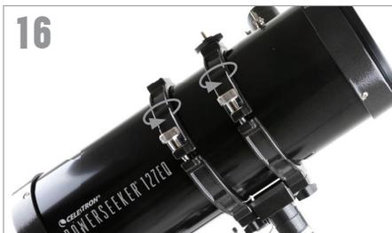
Placez le tube du télescope sur la moitié inférieure des anneaux, placez les moitiés supérieures sur le tube du télescope et vissez les molettes de fixation maintenant le tube en place. Assurez-vous que le système de mise au point est positionné au-dessus du contrepoids.
