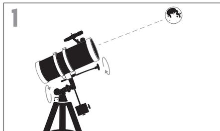
Con la Luna visible en el firmamento, instale el telescopio del modo descrito anteriormente con el ocular de 20mm instalado. Mueva el telescopio de forma que apunte aproximadamente a la Luna.
