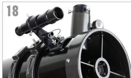
Identifiez le chercheur et retirez les capuchons de plastiques de l'avant et de l'arrière de la lentille. Orientez le chercheur de manière à ce que la fenêtre de verre soit orientée vers l'avant du tube, comme illustré ici. Placez le chercheur sur les tiges sur le tube et fixez-le avec les écrous striés.
