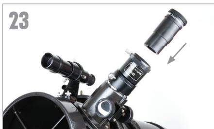
Ensuite, insérez l'oculaire dans la lentille de Barlow et serrez les vis de fixation pour le fixer.
