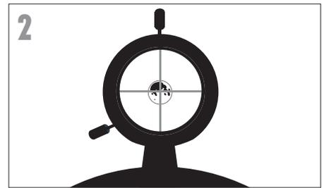
Regardez dans le chercheur et localisez le réticule du viseur. Continuez à déplacer le télescope jusqu'à ce que le viseur soit superposé sur la Lune.
