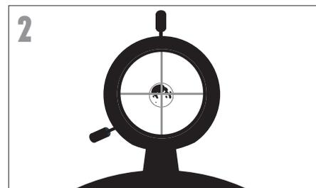
Osservare attraverso il cercatore e localizzare il reticolo. Continuare a muovere il telescopio fino a quando il reticolo appare sulla Luna.
