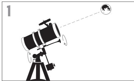
Lorsque la Lune est visible dans le ciel, installez votre télescope comme décrit ci-dessus, avec l'oculaire de 20 mm installé. Déplacez le télescope de manière qu'il pointe plus ou moins vers la Lune.
