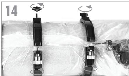
Retirez les anneaux de tube du tube de télescope en desserrant les molettes des colliers, sur le côté de chaque anneau. Retirez ensuite les deux écrous à ailettes situés sur la moitié inférieure de chaque anneau de tube.
