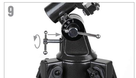
Compruebe la latitud aproximada de su ubicación de observación en internet o usando un mapa. A continuación, enrosque el tornillo de ajuste de latitud en el soporte ecuatorial hasta que la latitud quede indicada en la escala de latitud.
