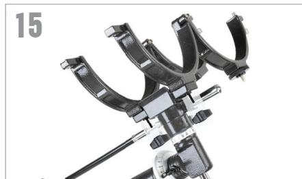
Alignez les trous de la moitié inférieure des anneaux sur les trous de la monture et sécurisez-les avec les écrous à ailettes noirs que vous avez retiré à l'étape 14.
