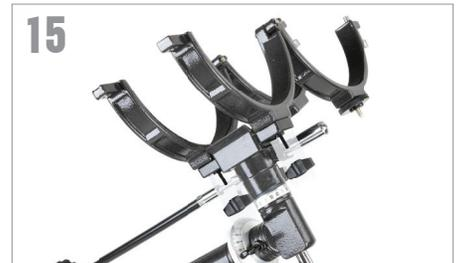
Alinee los agujeros de las arandelas de la mitad inferior del tubo con los agujeros del soporte y asegúrelos en posición con las roscas aladas negras retiradas en el paso 14.
