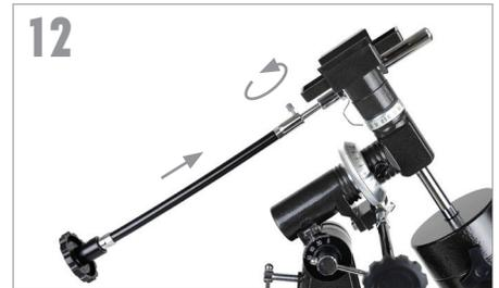
Deslice el extremo cromado de los cables de control de movimiento lento en el eje del engranaje del soporte ecuatorial. Asegúrese de alinear el tornillo sobre el punto plano del eje. Apriete el tornillo para fijarlo en posición.
