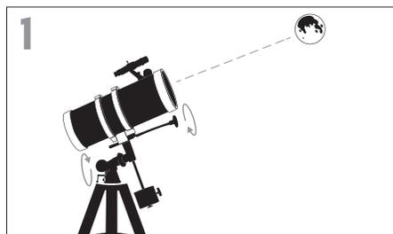
Quando la Luna è visibile in cielo impostare il telescopio come descritto sopra con installato l'oculare da 20mm. Spostare il telescopio in modo che punti approssimativamente verso la Luna.
