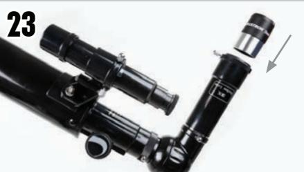
Ensuite, insérez l'oculaire dans la lentille de Barlow et serrez les vis de fixation.
