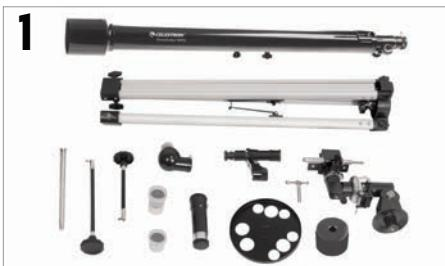
Packen Sie Ihr Teleskop aus und überprüfen Sie die Vollständigkeit aller Teile. Ihr PowerSeeker 60EQ umfasst: einen optischen Tubus, ein Stativ, eine äquatoriale Montierung, eine Breitengrad-Einstellschraube, einen Zenitspiegel, zwei Okulare und eine dreifach Barlowlinse, ein Sicherfernrohr, ein 1 kg Gegengewicht, eine Gegengewichtsstange, zwei Zeitlupenkabel und eine Okular-Zubehörablage.
