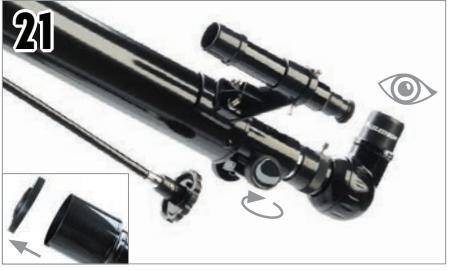
Rimuovere il tappo della lente dalla parte anteriore del telescopio. Per osservare, guardare attraverso l'oculare come mostrato sopra. Mettere a fuoco l'immagine ruotando le manopole al di sotto del foceggiatore.
