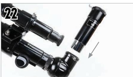
Pour obtenir un plus grand grossissement, vous pouvez utiliser la lentille de Barlow x3 incluse. Placez la lentille de Barlow dans le système de mise au point, à la place de l'oculaire. Retirez le capuchon de la lentille de Barlow.
