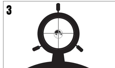
Regardez dans le chercheur et localisez le réticule. Continuez à orienter le télescope jusqu'à ce que le réticule soit superposé sur la Lune.
