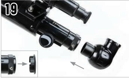
Allentare le viti sul foceggiatore in modo che non ostruiscano il diametro interno del foceggiatore. Inserire la diagonale nel foceggiatore e serrare le viti di regolazione. Rimuovere il tappo di plastica che copre l'estremità del foceggiatore.
