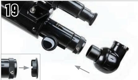
Desserrez les vis sur le système de mise au point, de manière à ce qu'elles ne pénètrent pas dans la surface interne du diamètre du système de mise au point. Insérez le renvoi coudé dans le système de mise au point puis serrez les vis de fixation. Enlevez le capuchon en plastique qui couvre l'extrémité du porte-oculaire.
