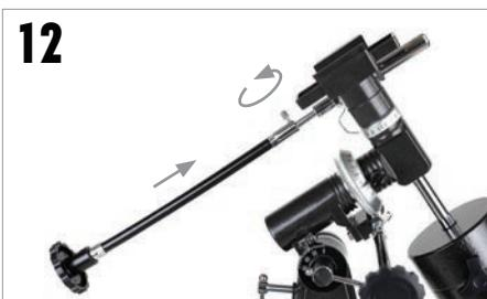
Deslice el extremo cromado de los cables de control de movimiento lento en el eje del engranaje del soporte ecuatorial. Asegúrese de alinear el tornillo sobre el punto plano del eje. Apriete el tornillo para fijarlo en posición.
