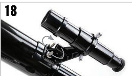
Nehmen Sie das Sucherfernrohr und entfernen Sie die Plastikkappen auf der Vorder- und Rückseite des Objektivs. Richten Sie das Sucherfernrohr so aus, dass das Glasfenster zur Vorderseite des Tubus zeigt, wie hier dargestellt. Platzieren Sie das Sucherfernrohr über den Stützen des Tubus und ziehen Sie es mit den Rändelmuttern fest.
