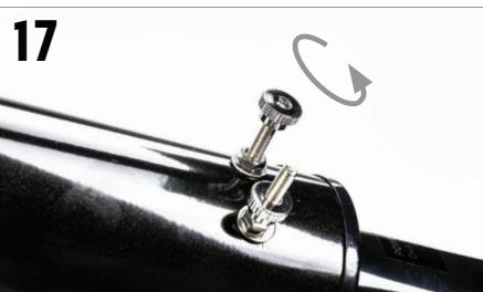
Saque las roscas estriadas del extremo del enfoque del tubo del telescopio.
