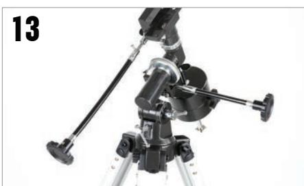
Il cavo deve fissarsi all'asse dell'ascensione retta e l'altro cavo deve fissarsi all'asse di declinazione. Serrare la vite per fissare il cavo in posizione.
