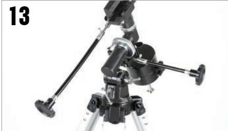
Ein Kabel muss an der Rektaszensionsachse und das andere an der Deklinationsachse befestigt werden. Ziehen Sie die Schraube fest, um das Kabel an der richtigen Position zu sichern.
