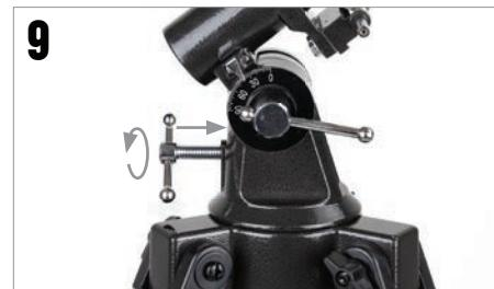
Trouvez la latitude approximative de votre site d'observation en cherchant sur Internet ou à l'aide d'une carte. Vissez ensuite la vis de réglage de la latitude dans la monture équatoriale jusqu'à ce que votre latitude apparaisse sur l'échelle de latitude.
