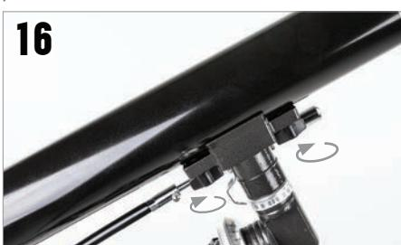
Fissare nuovamente entrambe le manopole e serrare in posizione. La parte anteriore del tubo deve trovarsi sul gruppo del contrappeso.
