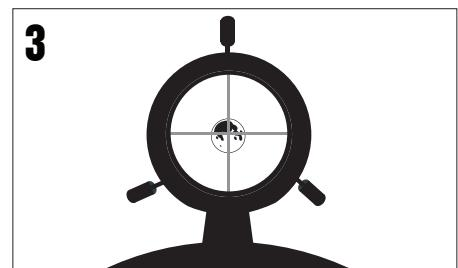
Osservare attraverso il cercatore e localizzare il reticolo. Continuare a muovere il telescopio fino a quando il reticolo appare sulla Luna.
