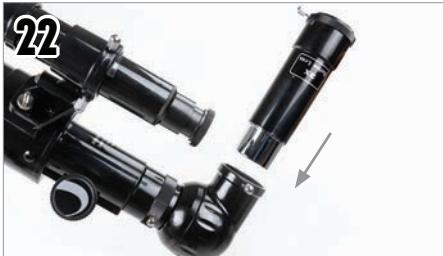
Sie können die mitgelieferte 3-fach Barlowlinse für eine zusätzliche Vergrößerung verwenden. Stecken Sie die Barlowlinse anstelle des Okulars in den Fokussierer. Entfernen Sie die Kappe von der Barlowlinse.
