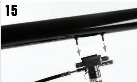
Ponga el tubo sobre el soporte alineando los tornillos con los agujeros de montaje del soporte.
