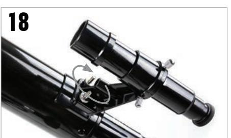
Localizzare il cercatore e rimuovere i tappi in plastica sulla parte anteriore e posteriore della lente. Orientare il cercatore in modo che la finestrella di vetro sia rivolta verso la parte anteriore del tubo come mostrato. Sistemare il cercatore sui perni del tubo e fissarlo mediante i dadi zigrinati.
