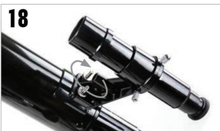
Localice el localizador y saque las tapas de plástico en la parte anterior y posterior de la lente. Oriente el localizador de forma que la ventana de cristal esté orientada a la parte anterior del tubo del modo indicado. Ponga el localizador sobre los postes en el tubo y apriételo con las roscas estriadas.
