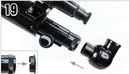
Lösen Sie die Schrauben am Fokussierer, damit sie den Innendurchmesser des Fokussierers nicht behindern. Setzen Sie den Zenitspiegel in den Fokussierer ein und ziehen Sie die Stellschrauben fest. Entfernen Sie die Plastikabdeckung, die das Ende des Fokussierers abdeckt.
