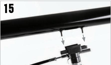
Placez le tube sur la monture en alignant les vis avec les trous de montage sur la monture.
