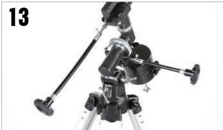
Le câble doit s'attacher à l'axe d'ascension droite et l'autre câble à l'axe de déclinaison. Serrez la vis pour fixer le câble en position.
