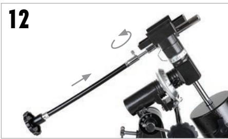
Schieben Sie das verchromte Ende der Zeitlupe-Kontrollkabel auf die Getriebewelle der äquatorialen Montierung. Achten Sie darauf, dass die Stellschraube über der flachen Stelle auf der Welle ausgerichtet ist. Ziehen Sie die Schraube fest, um sie zu sichern.
