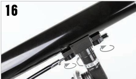
Remettez les molettes en place et serrez-les pour maintenir en place. L'avant du tube doit se trouver au dessus de l'ensemble de contrepoids.
