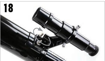
Identifiez le chercheur et retirez les capuchons de plastiques de l'avant et de l'arrière de la lentille. Orientez le chercheur de manière à ce que la fenêtre de verre soit orientée vers l'avant du tube, comme illustré ici. Placez le chercheur sur les tiges sur le tube et fixez-le avec les écrous striés.
