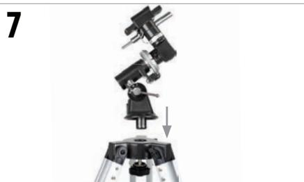
Individuare la montatura equatoriale e inserire la base attraverso il foro posto al centro della piattaforma di montaggio del treppiede.
