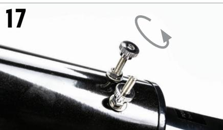
Entfernen Sie die Rändelmuttern am Fokussierende des Teleskop-Tubus.
