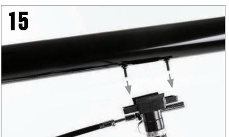
Sistemare il tubo sulla montatura allineando le viti ai fori di montaggio sulla montatura.
