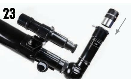
A continuación, inserte el ocular en la Barlow y apriete los tornillos para asegurarlo en posición.
