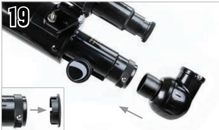
Aloje los tornillos del enfoque de forma que no obstruyan el diámetro interno del enfoque. Inserte la diagonal en el enfoque y apriete los tornillos. Saque la tapa de plástico que cubre el extremo del enfoque.
