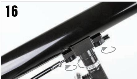
Bringen Sie beide Knöpfe wieder an und ziehen Sie sie fest. Die Vorderseite des Tubus muss über der Gegengewichtsbaugruppe positioniert werden.
