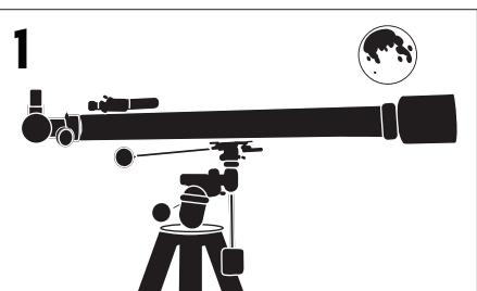
Quando la Luna è visibile in cielo impostare il telescopio come descritto sopra con installato l'oculare da 20mm.
