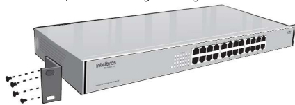
Fixação dos suportes em "L"
